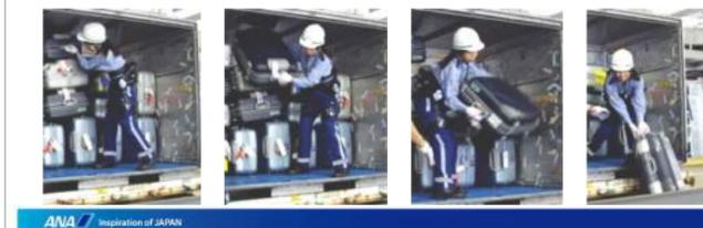
空港のグランドハンドリング各業務（手荷物や貨物の積み付けや解体等）における腰部負担リスクについて、HALに内蔵されたセンサーから装着者の姿勢関節角度や、生体電位信号、アシスト力を計測し、それらのデータから力学モデルによる4つの負担を計測し、定量的に評価。
